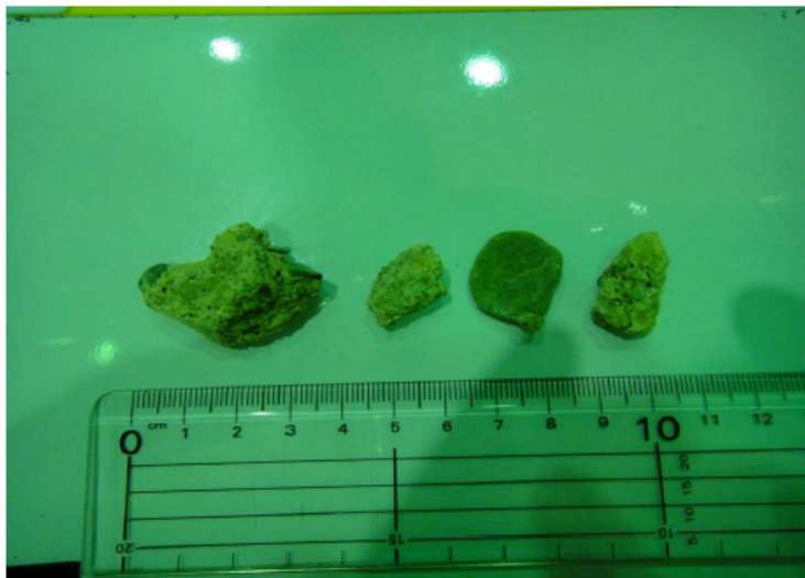
燃料集合体の間から採取した瓦礫
